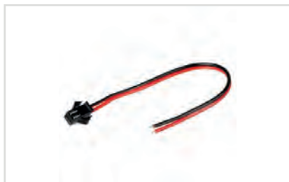
Артикул 022317 Разъем ПАПА (система "клик") для соединения отрезков одноцветных светодиодных лент. Корпус черный. Провод 20AWG, длина 15 см. Максимальный допустимый ток 3А.
