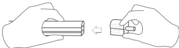
Рис. 1. Установка коннектора питания
