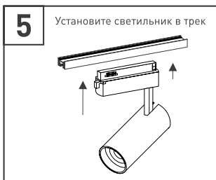
Рис. 2. Установка и подключение светильника
