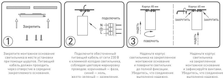
Рис. 3. Установка светильника
