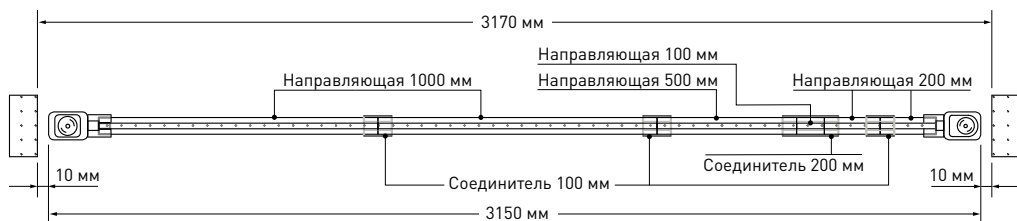
Рис. 3. Пример сборки направляющей длиной 3.15 м
