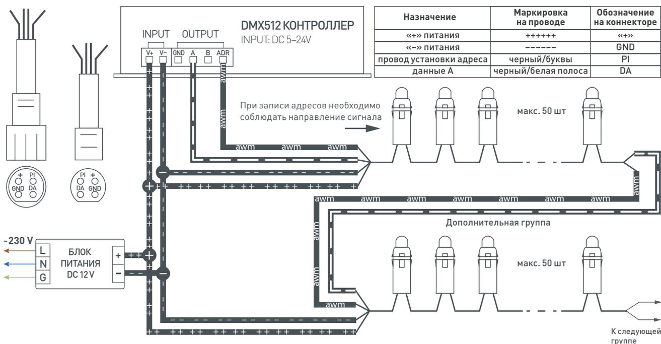
Схема подключения светодиодных модулей
