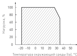
Рис. 6. Максимальная допустимая нагрузка, % от мощности источника
